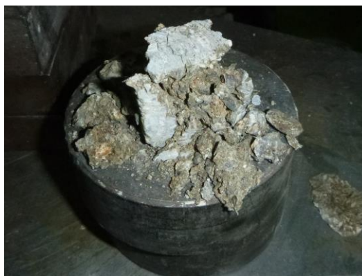
Vzorek K1 po zkoušce pevnosti v tlaku
